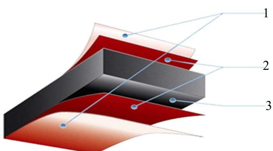
1. слой – защищающий от механического воздействия
